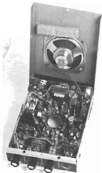
Togliendo le viti poste lateralmente sul contenitore in metallo del ricetrasmittitore si può facilmente accedere agli zoccoli porta quarzi in cui debbono essere inseriti i cristalli per il controllo di frequenza dell'emissione e della ricezione. Normalmente l'apparecchio viene fornito con una coppia di quarzi.
