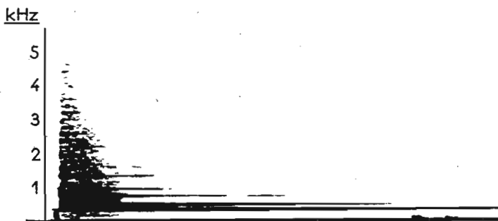
Analisi spettrografica del suono di un lyu cinese. Al momento del colpo si produce un rumore d'impatto complicato con numerose componenti armoniche. Sotto, sovrapposizione degli effetti di una serie di 16 lyu .
